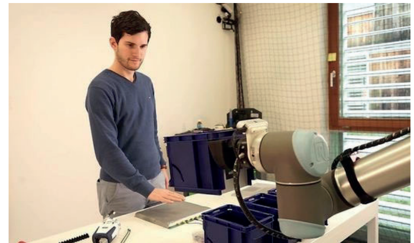
Mithilfe von Handzeichen soll eine intuitive Interaktion mit dem Roboter möglich sein © Joanneum
